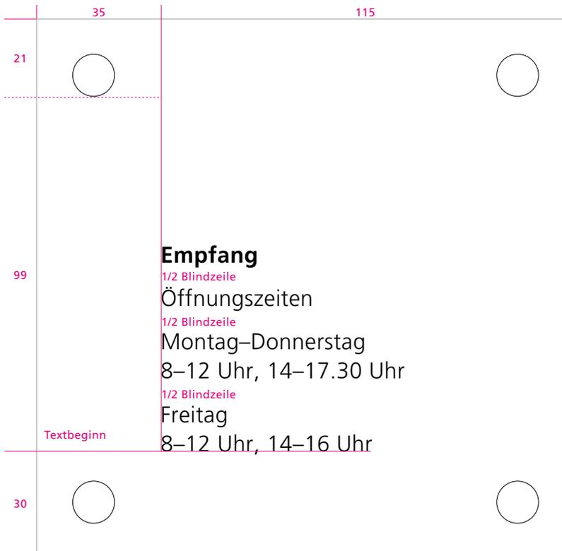
Format 150 x 150 mm, verkleinerte Darstellung, alle Angaben in Millimeter
