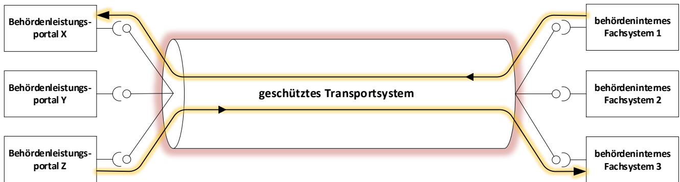
Abbildung 71: Geschütztes Transportsystem für den zielgerichteten Datenaustausch bzw. die bidirektionale Kommunikation zwischen Behördenleistungsportalen und behördeninternen Fachsystemen
